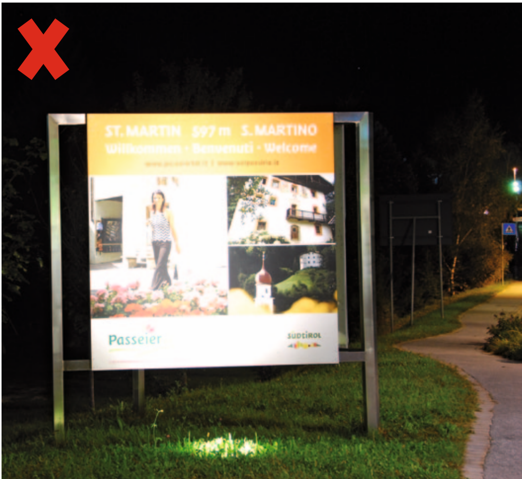
Abbildung 27: Schilderbeleuchtung von unten nach oben in der Gemeinde St. Martin in Passeier
